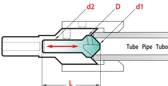
Utilisation simultanée des deux fraises, pour l'ébavurage inter-exter de tubes.
