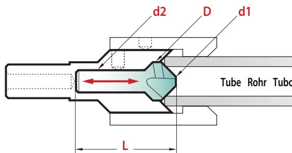
Utilisation simultanée des deux fraises, pour l'ebavurage inter-exterieur de tubes.
